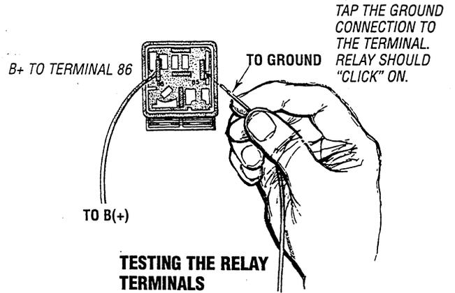
TAP THE GROUND CONNECTION TO THE TERMINAL. RELAY SHOULD "CLICK" ON.
